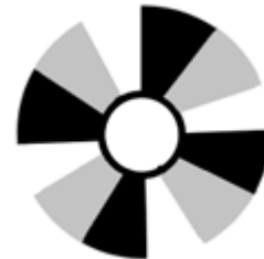
Fig. 4 Tri-color slot Encoder Disc
